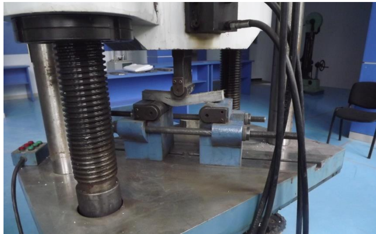
სურ. 4. ბაზალტის პოლიმერული კომპოზიტის ნიმუშის ღუნვის სიმტკიცეზე გამოცდა.
